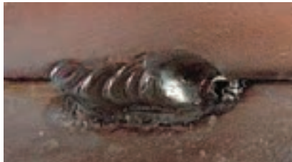
شکل ۴-۵۹: مقطع ای باید کوچک و یکنواخت باشد تا تاثیر به جوش نهایی نداشته باشد
