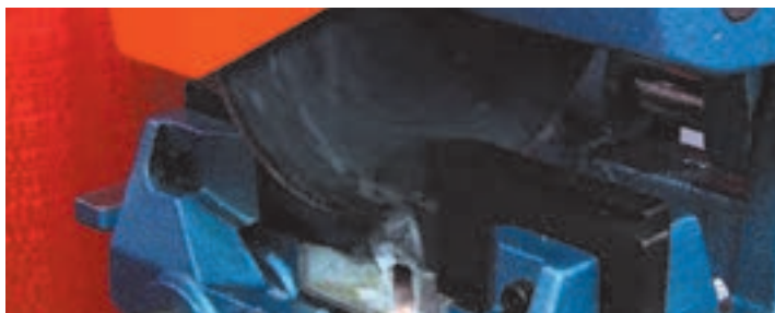
شکل ۱-۱۹- برشکاری با اره آب صابونی
