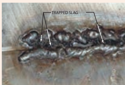
شکل ۴-۶: عیب ایجاد شده در اثر حرکت سریع الکتروده در عرض جوش
