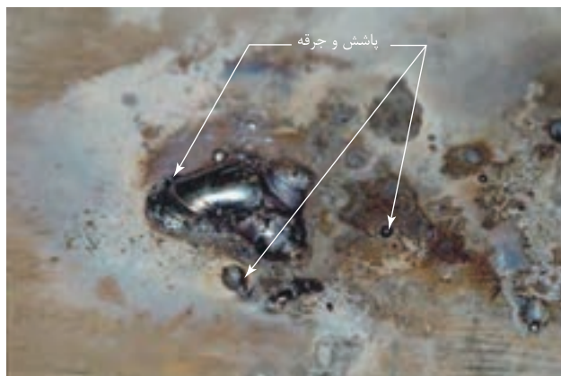
شکل ۴-۳۶: پاشش سخت شده بر روی فلز پایه
