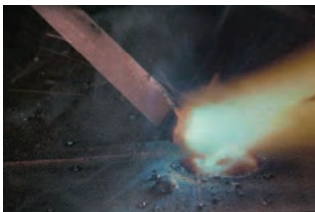
شکل ۴-۳۲: برقراری قوس با الکتروودی که روکش آن کنده شده (عدم برقرار قوس پایدار)
