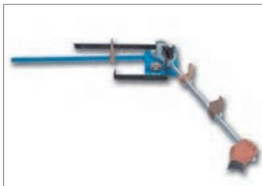
شکل ۳-۵- خم‌کاری دستی تسمه با ابزار کمکی
