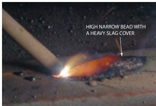
شکل ۴-۳۸: جوشکاری با طول قوس بسیار کم
