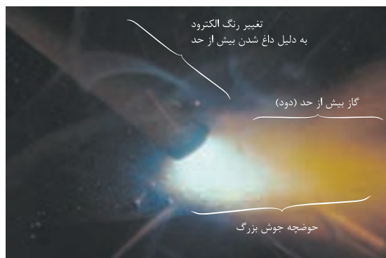
شکل ۴-۳۵: جوشکاری با آمپر بسیار بالا
