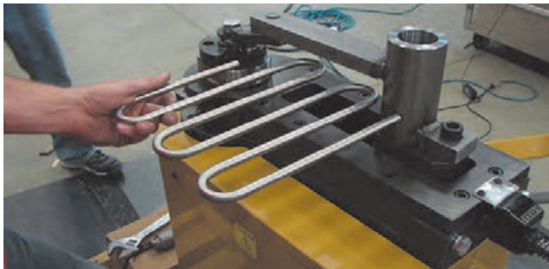
شکل ۲-۷: لوله خم شده - مبدل حرارتی -
