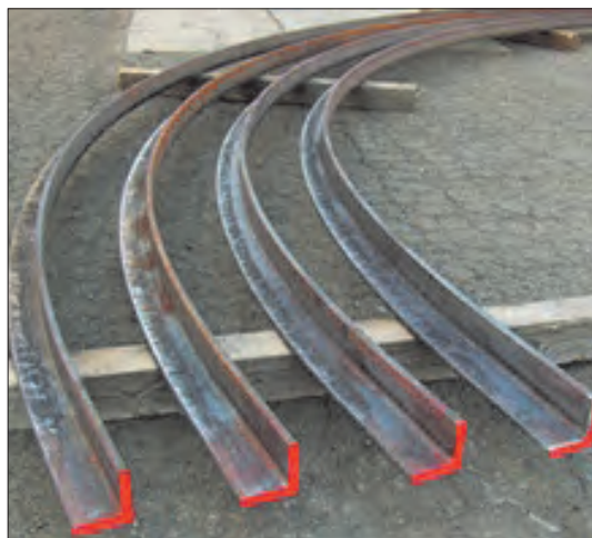
شکل ۳-۲۱- پروفیل با شعاع خم متفاوت
