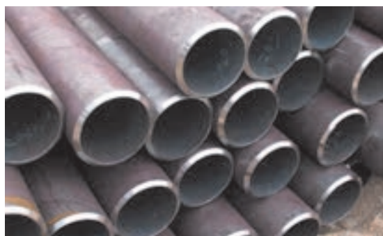
شکل ۳-۲ - لوله بدون درز
