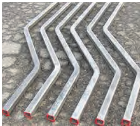
شکل ۳-۲۱- پروفیل با شعاع خم متفاوت
