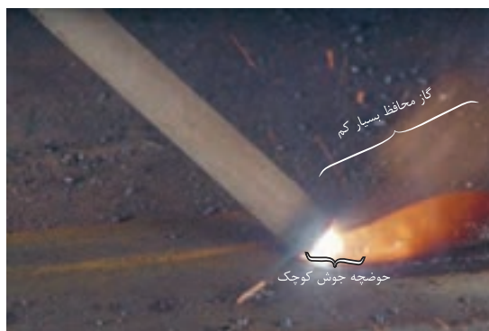
شکل ۴-۳۴: جوشکاری با آمپر بسیار پایین
